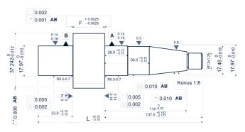
泵齒輪可以在一次夾持中完成全面的研磨。形狀 和位置公差可以輕鬆實現。
