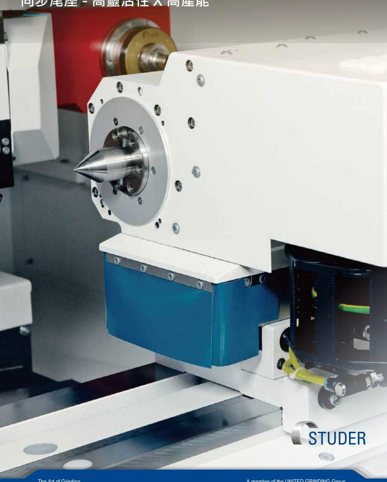
尾座同步驅動到工件主軸,利用工件中心部的摩擦力增加驅動扭矩,在最簡單的應用情境中,僅需兩個標準頂心即足以因應傳統研磨、甚至 140 m/s 的高速研磨。工件可以無須額外驅動器輔佐下,於單次夾持中進行完整加工,其研磨的形狀和位置精度亦能得到提升。
