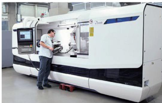
高端機床和高度複雜的磨削系統 STUDER S41
